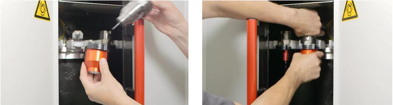
Danach wird der Düsenkörper mit der Werkzeugaufnahme im Werkzeugmagazin abgelegt. Zur Aufnahme eines neuen Werkzeugs fährt die Spindel (der Greifer) in das Werkzeugmagazin und holt sich Düsenkörper und Werkzeug gemeinsam ab. Dabei wird der Düsenkörper mittels eines Klickmechanismus in der Spindeladaption befestigt. Gleichzeitig wird die Werkzeugaufnahme wie üblich in die Spindel eingewechselt.
