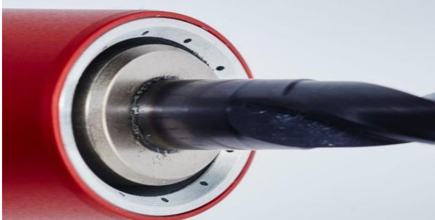
Durch 16 Düsen an der Unterseite des Mediumverteilers strömt während der gesamten Bearbeitung Luft oder ein Luft-Schmiermittel-Gemisch mit einem konstanten Druck von 6 Bar. Durch die präzise ausgerichteten Düsen trifft der starke Luftstrahl exakt auf die Fräzerschneide. Auf diese Weise werden in allen Bearbeitungssituationen die Späne sofort und dauerhaft vom Werkstück weggeblasen.
